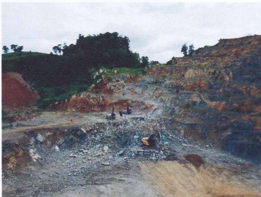
รูปที่ 10 แสดงสภาพพื้นที่หน้าเหมืองบริเวณทิศตะวันออกเฉียงเหนือของประทานบัตร มีการทำเหมืองเป็นแบบขั้นบันได ภาพนี้ มองไปทางทิศตะวันออกเฉียงเหนือ
