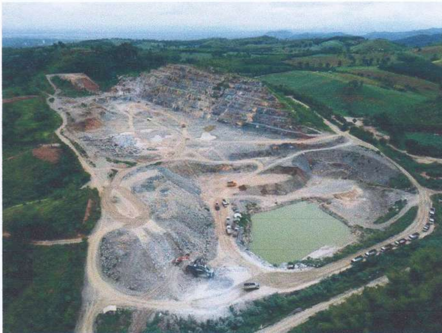
รูปที่ 8 แสดงสภาพพื้นที่หน้าเหมืองบริเวณตอนกลางประทานบัตร มีการทำเหมืองเป็นแบบขั้นบันได ภาพนี้มองไปทางทิศตะวันออกเฉียงเหนือ
